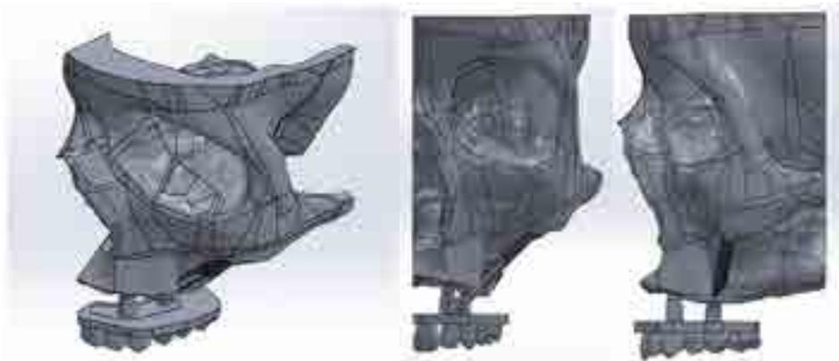
Figura 1. CAD del ensamblaje de las diferentes partes generadas tanto para extra maxilar como intrasinusal
