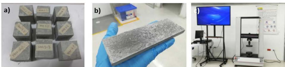
Imagen 1. Probetas de fibrocemento adicionadas con las diferentes formas de sílice: a) Probetas de fibrocemento para ensayos de compresión, b) placas para ensayos de flexión, c) máquina universal de ensayos.
