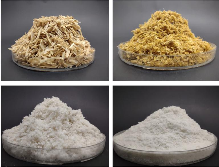
Figura 1. Transformación de la cascarilla de arroz en celulosa
