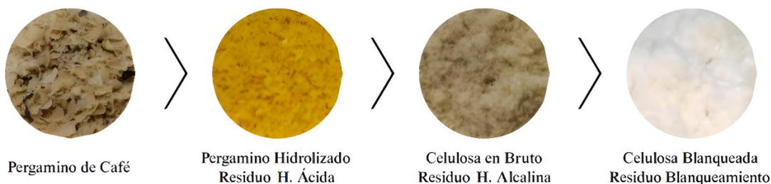
Figura 1. proceso químico para la obtención de microfibras de celulosa
