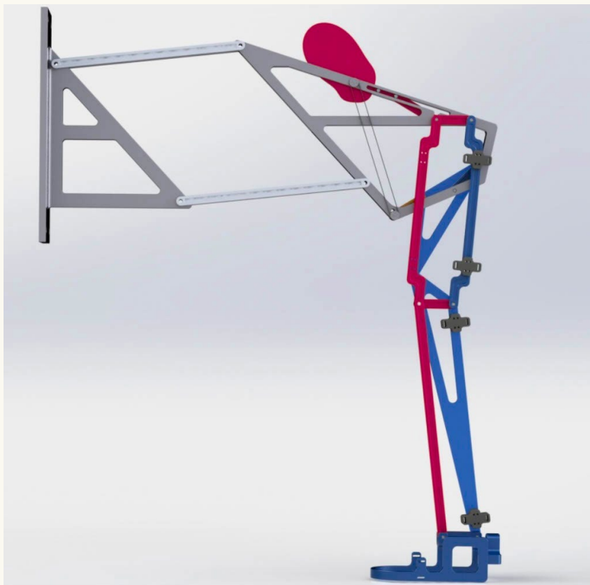
Figura 9. Ejemplo de alternativa A1. Mecanismo tipo Stephenson III
