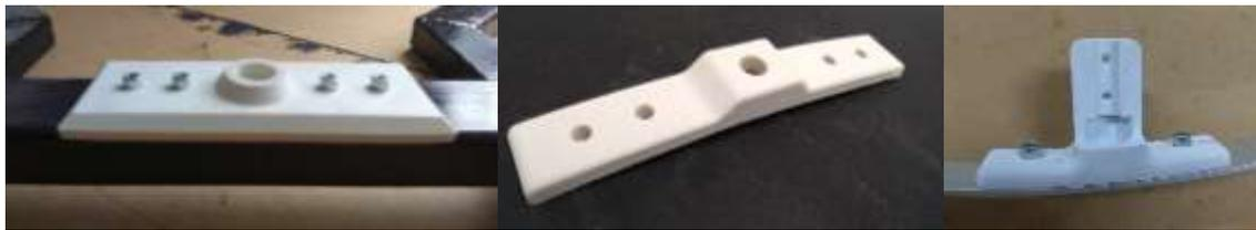
*Figura 2. Piezas de acople obtenidas por impresión 3D*
