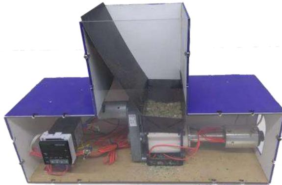
*Figura 2. Sistema de extrusión de material.*
