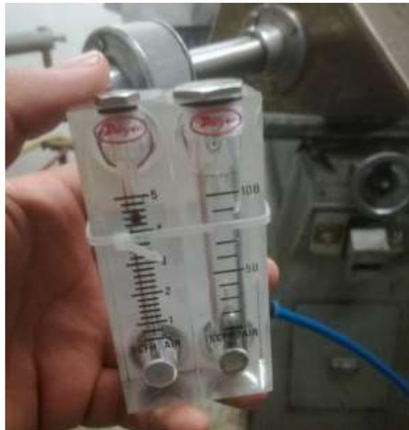
Figura 3. Medición del caudal de gas
