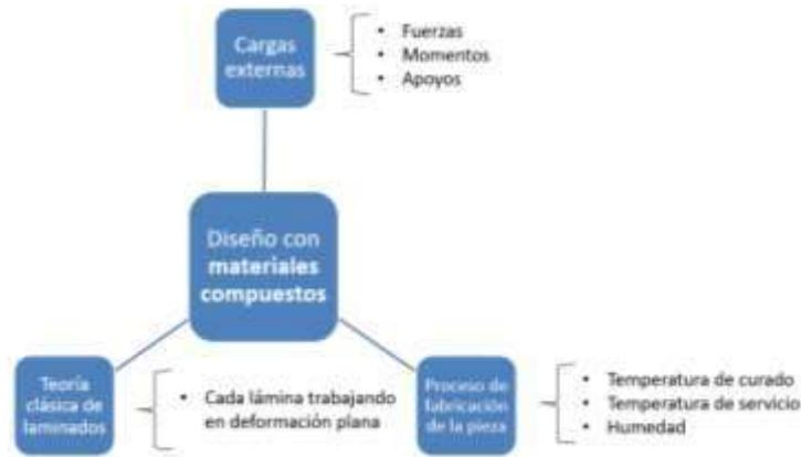
Figura 1. Elementos a considerar en el diseño con materiales compuestos.
