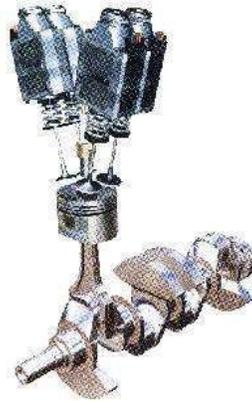
*Figura 9: tren valvular electromagnético [8]*
