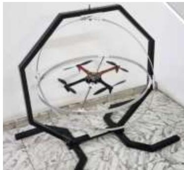
Figura 1. Prototipo de pruebas (Giroscopio)
