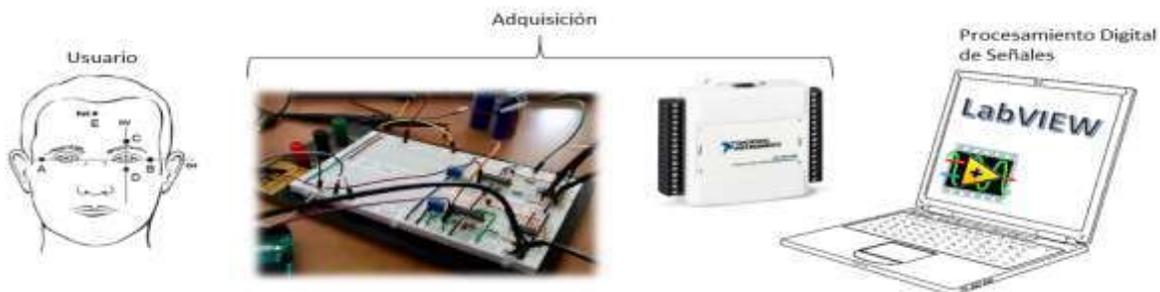
Figura 1. Diagrama de bloques del EOG.
