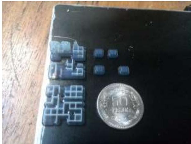
Figura 5: Antenas impresas en equipo Eden 260V.
