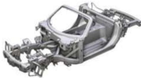
*Figura 3: estructura monocasco de automóvil, basada en rieles hidroformados
