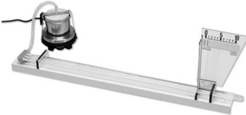
**Figura 5.2.** Montaje para dilatación lineal
