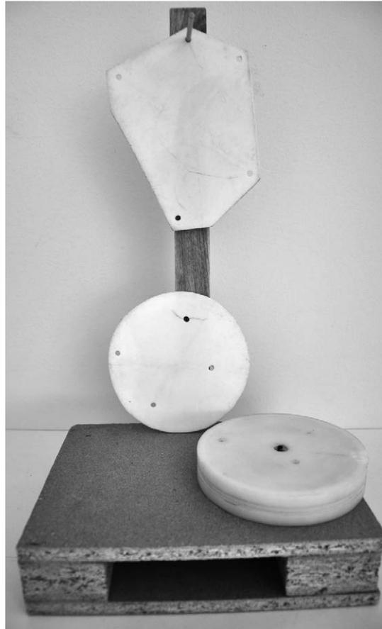
Figura 8.2 Montaje Péndulo Físico
