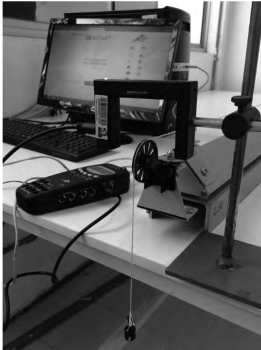
**Figura 10.1** Montaje para la segunda ley de Newton.
