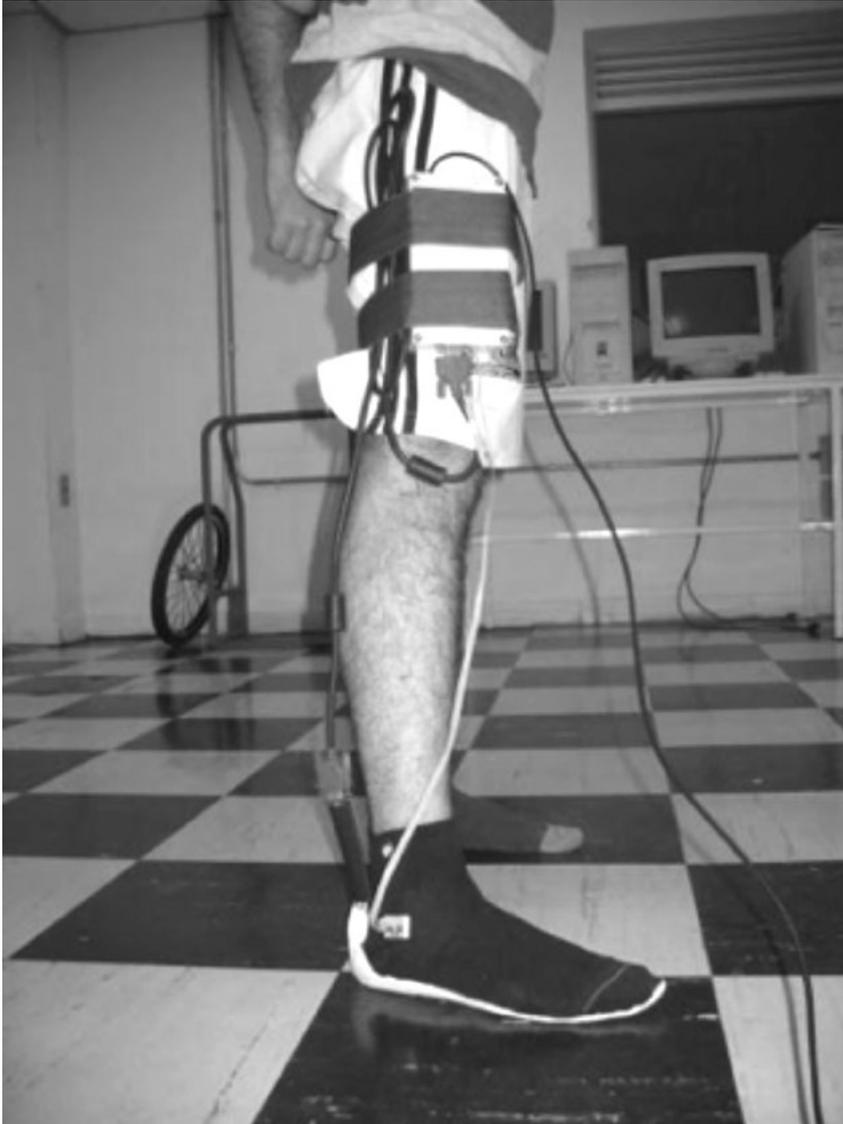
Prototipo de plantilla basado en sensores inerciales
